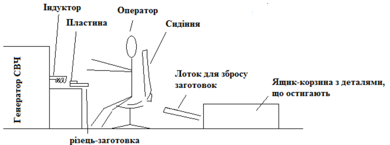
Рис. 3 Вплив високих температур на робоче місце оператора від установки СВЧ (джерело 11) при технологічній операції - пайка.
