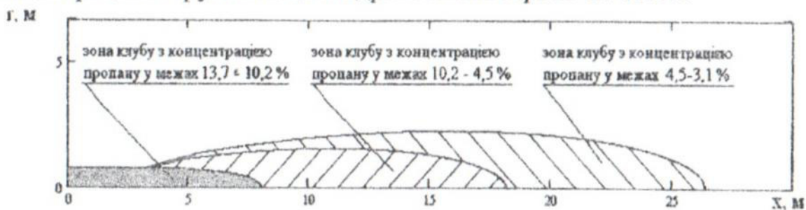
Рис. 1. Розподіл масової концентрації пропану в струмені, що розвивається в повітрі за умов концентрації пропану 13,7% на виході з отвору резервуару
