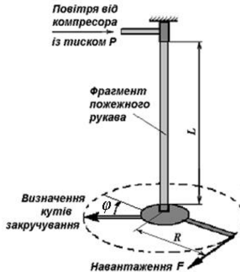
Рис. 1. Дослідна установка зі встановленим фрагментом рукава
