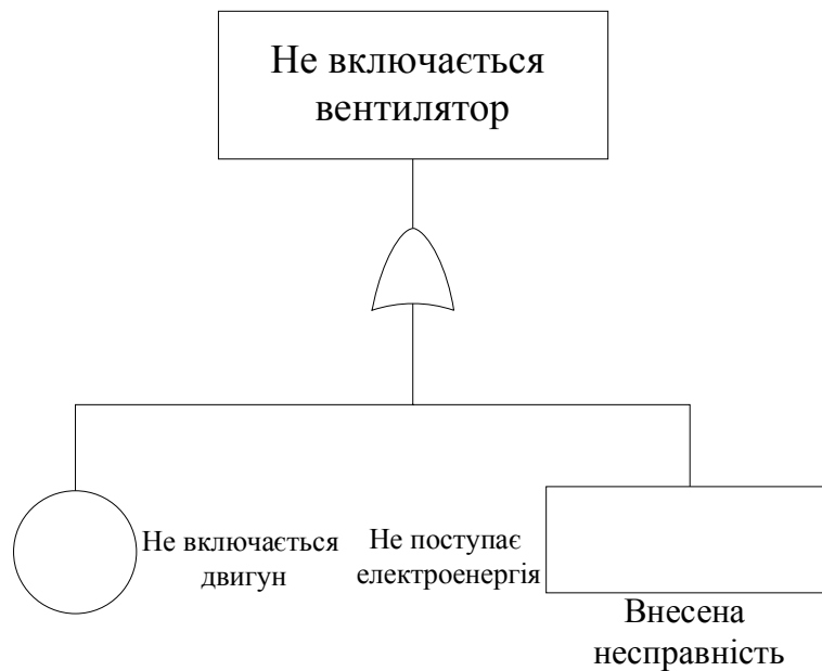
Рис. 2 – Дерево несправностей на випадок вторинних відмов
