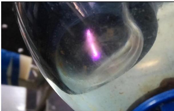
Рисунок 1 – Фото разряда в газовом пузыре внутри жидкости
