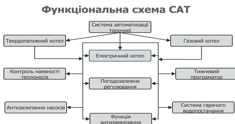
Рисунок 1 – Функціональна схема системи автоматизації топочної
