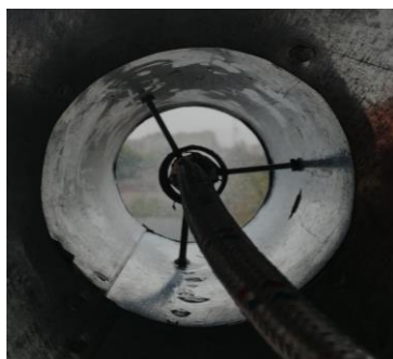
Рисунок 6 – Зображення змішувальної камери ВПЕ (з боку конфузору) після подачі води
