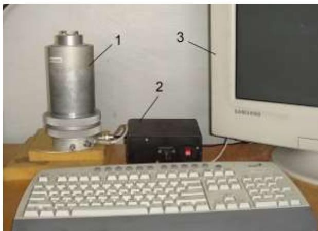
Рис. 1 – Внешний вид спектрометрического стенда для измерения сцинтиляционных характеристик детекторов на основе системы сцинтиллятор – PIN ФД.
