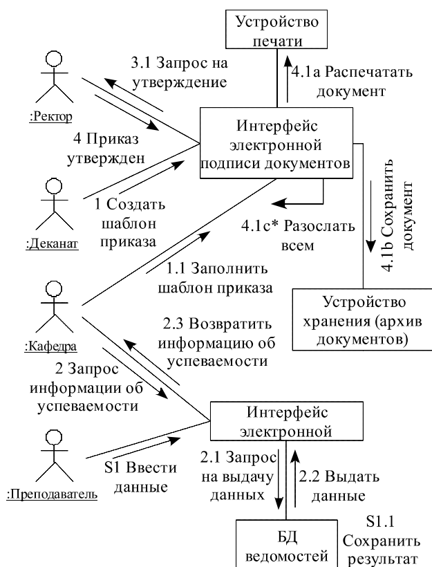
Рис. 7. Диаграмма кооперации для подсистемы приказов по прецеденту «Перевести студентов на следующий курс»
