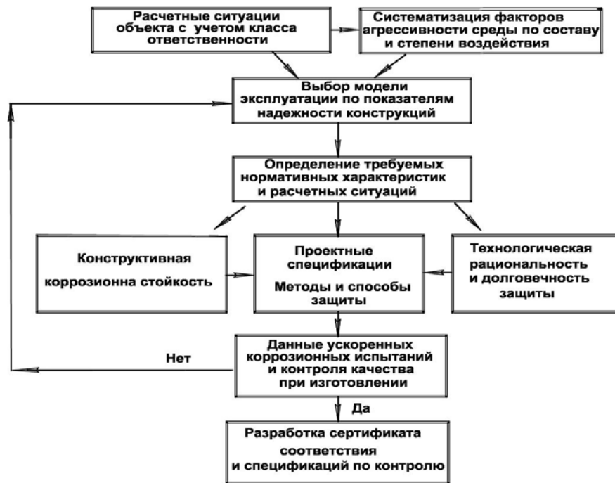
Рис. 1. Последовательность конструкторских и технологических мер первичной и вторичной защиты при изготовлении конструкций с гарантированной долговечностью
