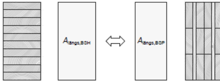
Рис. 2. Схема расположения ламелей в поперечном сечении балки из клееной древесины (слева) и из ортогональной клееной древесины – Brettspertholz (справа), рисунок приведен из [8]
