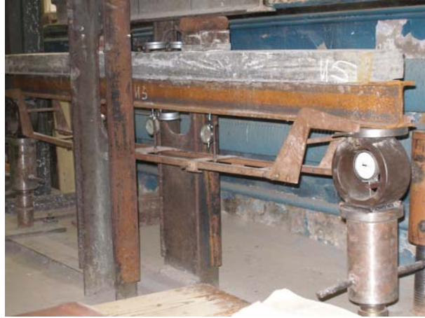
Рис. 2. Подготовленная к испытаниям балка (нагружение положительным моментом)
