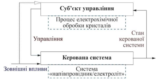
Рисунок 2 – Загальна схема системи управління процесом електрохімічного розчинення кристалу
