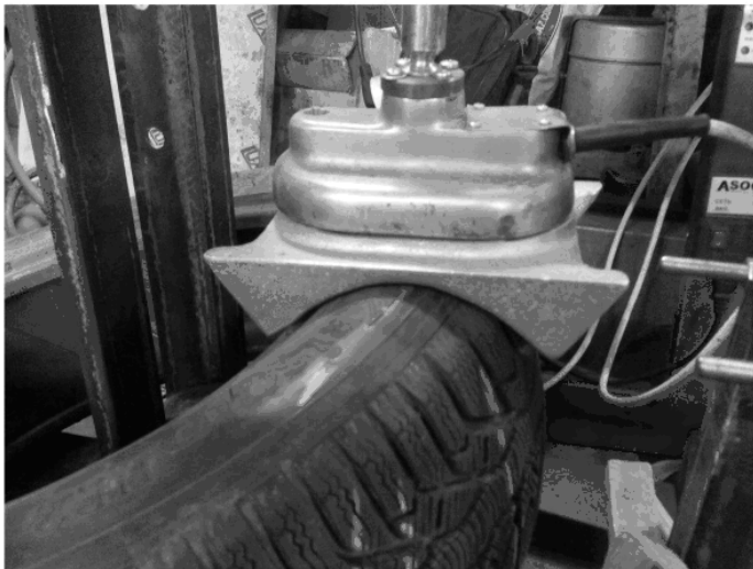
Рис. 2. Контрольна вулканізація автомобільної шини
