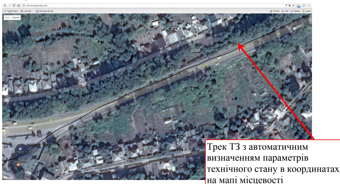
Рис. 1. Робоче вікно для визначення дорожніх умов експлуатації ТЗ на основі мережевих даних і програмного модуля Torque
