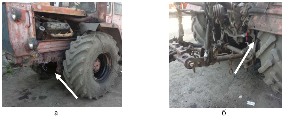
Рис. 1. Установка датчиков МРИК на шарнирно-сочлененной машине: а – на передней секции; б – на задней секции
