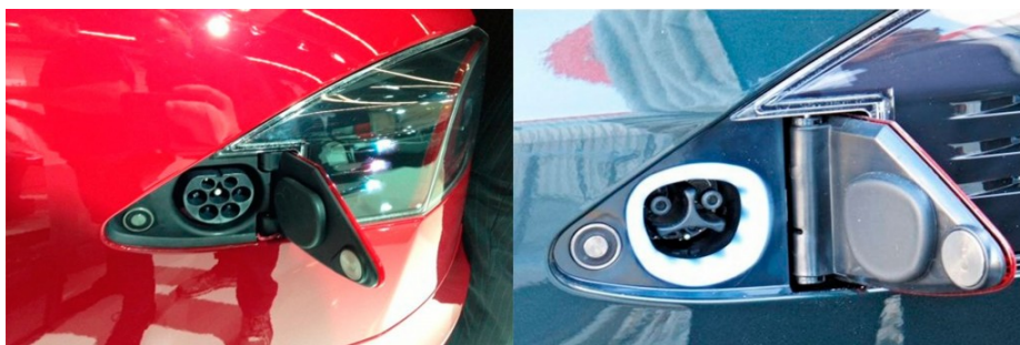
Рис. 3. Рознімання електромобілів Tesla для євrorинку й США
