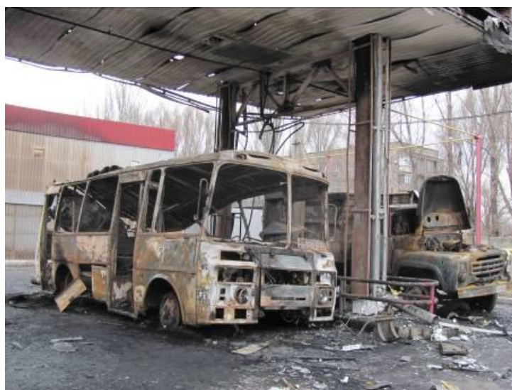
Рис. 1. Повреждения в результате взрыва метано-воздушной смеси автотранспортных средств и строительных конструкций на многотопливном автозаправочном комплексе
