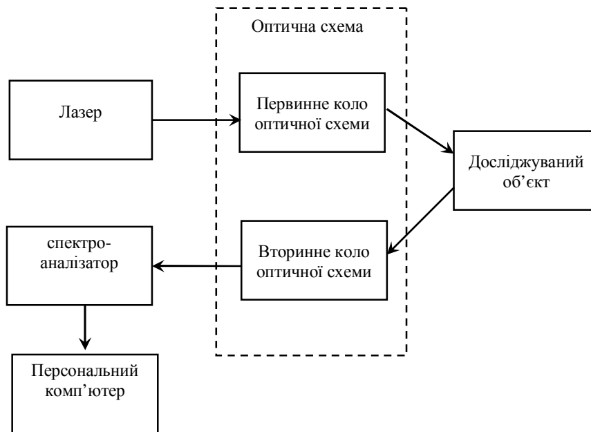
Рис. 1. Структурна схема засобу вимірювання температури на основі методу комбінаційного розсіювання світла
