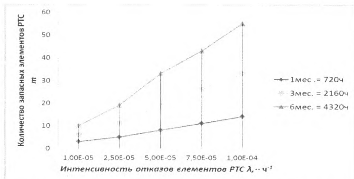
Рисунок 1 – График функции m = f(N, \lambda, t_n) , при N=100 ; T_n=720\text{ч}; 2160\text{ч}; 4320\text{ч} , \lambda=10^{-5} - 10^{-4}\text{ч}^{-1}
