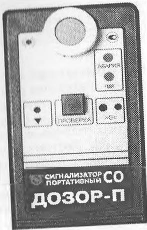
Рисунок 3 – Портативный сигнализатор-СО "ДОЗОР-П"
