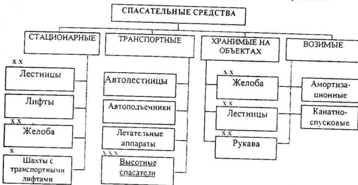
Рисунок 1 - Классификация спасательных средств и устройств: x - не требующая специальной подготовки или присутствия пожарных; xx - обеспечивающая непрерывность эвакуации; xxx - с улучшенными тактико-техническими характеристиками.
