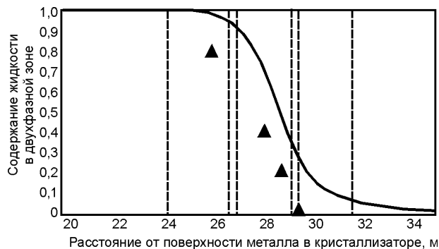
Рис. 4. Содержание жидкой фазы на оси слитка. Коэффициент регулирования теплообмена 0,82
