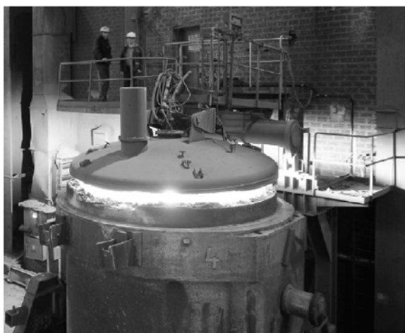
Рис. 15. Разогрев 60-т ковша газокислородной горелкой на заводе Ovako, Hofors Works
