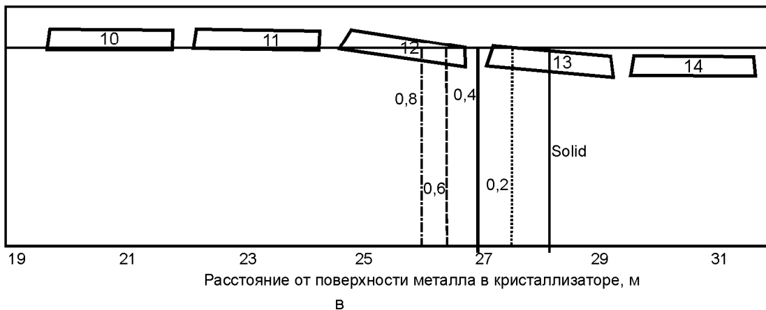
Рис. 1. Показания датчиков растворов и давлений в гидроцилиндрах сегмента № 13 для определения физических границ кристаллизации слитка (а): 1 — величина раствора роликов на входе в сегмент, мм; 2 — величина раствора роликов на выходе из сегмента, мм; 3 — давление на входе в сегмент, кН; 4 — давление на выходе из сегмента, кН; изменение положения солидуса по модели DSC в нестационарном режиме разливки (б): 1 — скорость разливки, м/мин; 2 — положение изолинии солидуса по модели DSC, м; 3 — положение границ сегмента № 13, м; 4 — положение центра сегмента № 13, м соответствие рассчитанных по модели DSC положений изолиний содержания жидкой фазы в зумпфе и позиционирования сегментов (в) при коэффициенте регулирования теплообмена 0,82, сечение 300×2500 мм, [C] = 0,067\%
