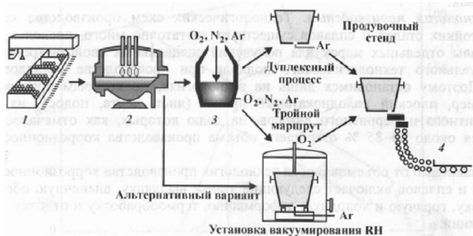
Рис. 9. Схема современной технологии выплавки нержавеющей стали
