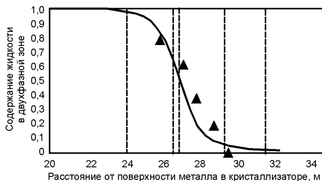
Рис. 5. Содержание жидкой фазы на оси слитка. Коэффициент регулирования теплообмена 0,70
