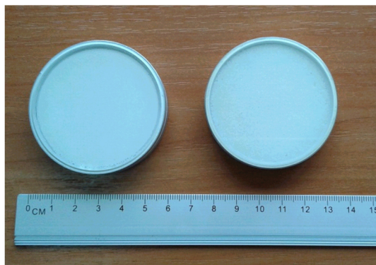
Рис. 1. Композиционные детекторы {}^6\text{LiI}(\text{Eu}) с размером гранул 40-63 мкм (слева) и 100-500 мкм (справа)
