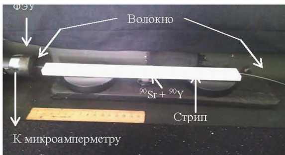
Рис. 5. Установка для измерения светового выхода сцинтилляционных
