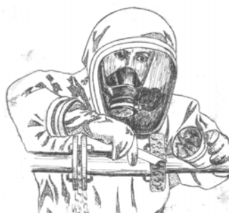
Рис. 7.3 – Герметизація фланцевих з'єднань
