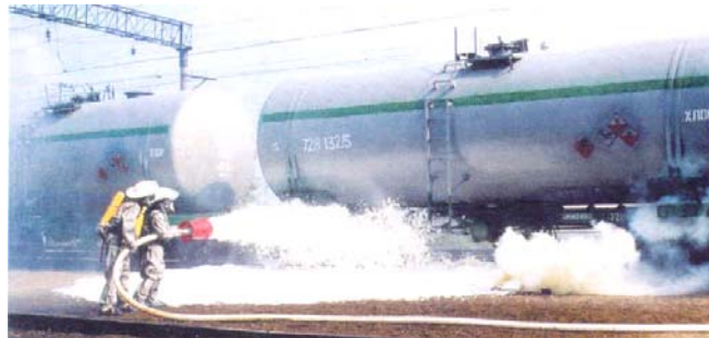
Рис. 6.2 – Накриття шаром піни місця розливання НХР
