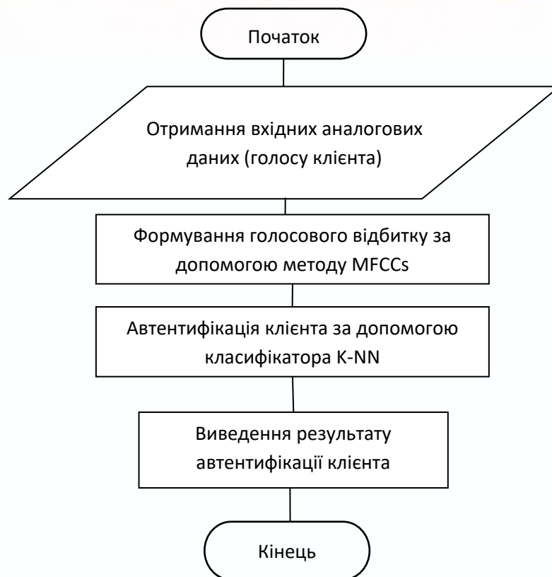
Рис. 1. Основні етапи удосконаленого методу автентифікації клієнтів за голосовим відбитком в режимі реального часу
