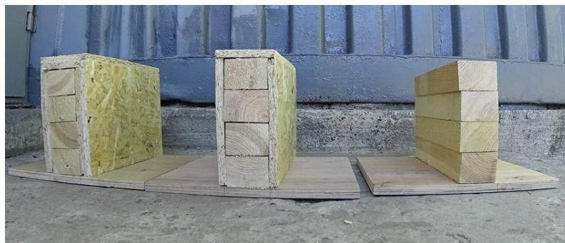
Рисунок 1 – Готові зразки-фрагменти дерев'яної балки без вогнезахисту та з вогнезахисним облицюванням
