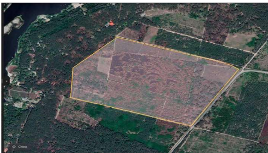
Рис. 1. Визначення пожежі за допомогою ресурсу Google Earth.
