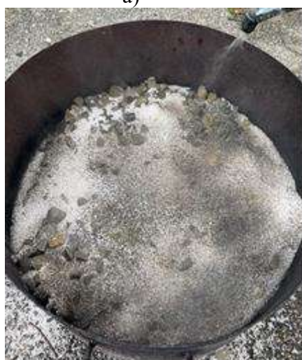
Рис. 1. Етапи гасіння модельного вогнища пожежі «8В»: а) зменшення висоти полум'я під час подавання ПС; б) зменшення висоти полум'я під час подавання ПС; в) припинення горіння після подавання води; г) дослід на повторне займання.
