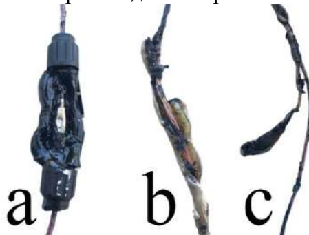
Рис. 3. З'єднувач (а) та провідники (b), (c) після випробування.
