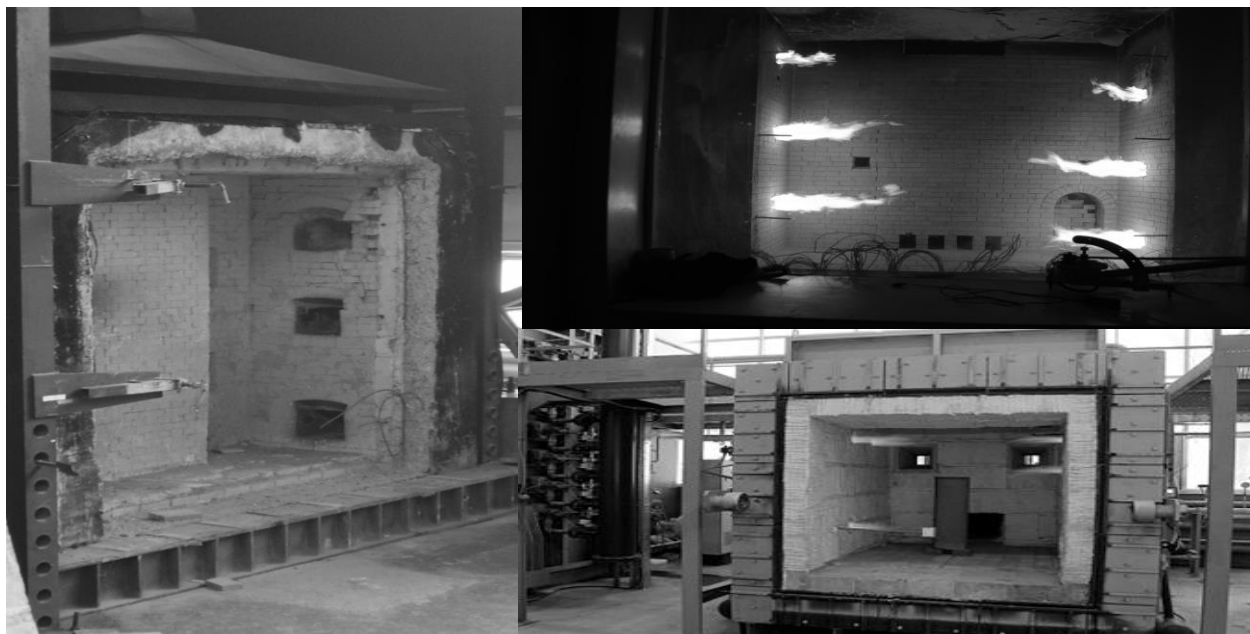
Рис. 1.2 – Вертикальні вогневі випробувальні установки для проведення випробувань на вогнестійкість несучих стін
