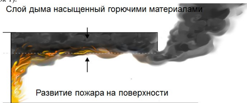
Рисунок 1 – Общий вид горящего помещения
