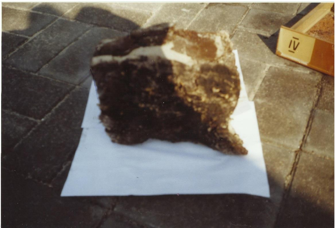
Рис. 4.4. Зразки торфу після експерименту. а) зразок з піском; б) зразок з глиною.
