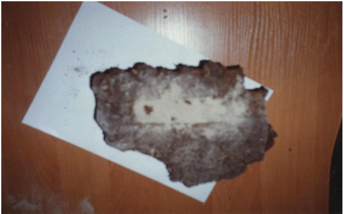
Рис. 4.3. Моноліт торфу зі щілиною, що заповнена піском. а) зразок без піску; б) зразок з піском.
