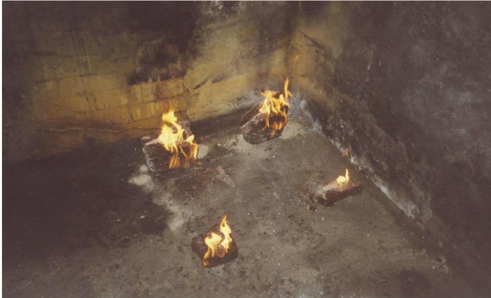
Рис. 4.1. Горіння зразків торфу в газодимокамері.
