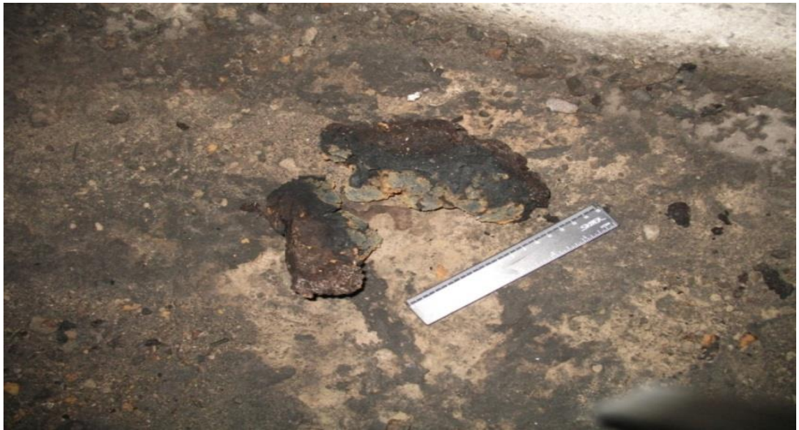
Рис. 2.9 Вигляд торфу після тління.
