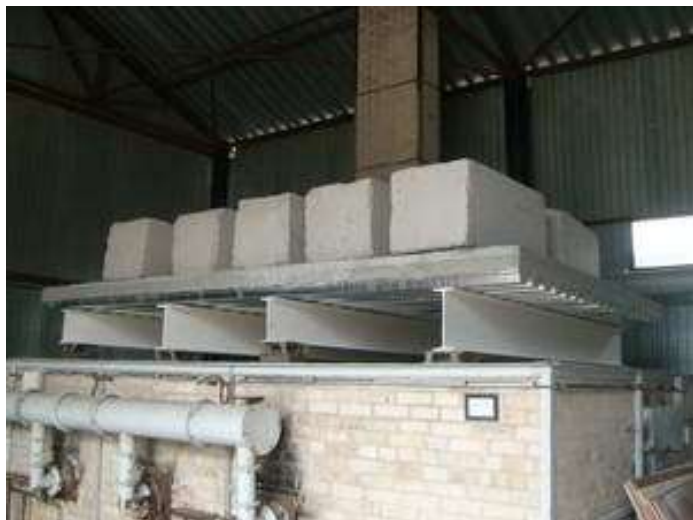
Рис. 1 Вигляд навантажень балок до початку випробувань
