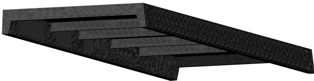
Рисунок 2 – Кінцево-елементна модель залізобетонної ребристої панелі покриття.
