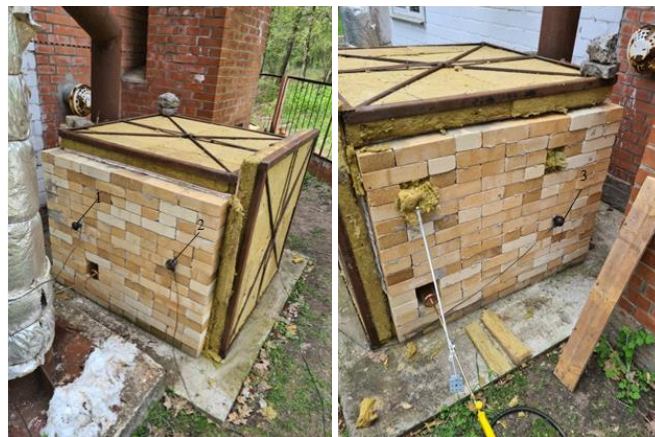
Рис. 2. – Расположение термопар в стенах испытательной установки при исследовании температурного распределения в камере печи: 1-3 – термопары типа ТХА.
