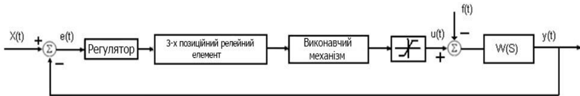
Рис. 1 – Контур регулювання рівня води в барабані
