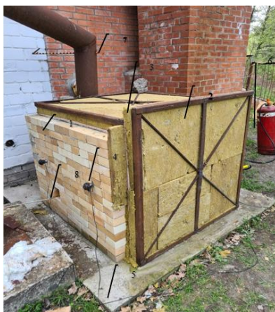
Рис. 1. – Прототип компактной установки для испытаний железобетонных и сталежелезобетонных строительных конструкций в условиях теплового воздействия пожара: 1-п-образный короб; 2-3-съемные крышки; 4-термопара; 5-силовой пол (фундамент); 6-газовая установка; 7-дымоход для выхода продуктов горения; 8-отверстие для установки горелок.
