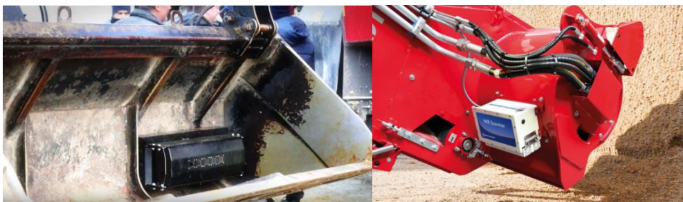
Рис. 1 – Анализаторы кормов, встраиваемые в рабочие органы погрузочных машин
