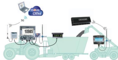
Рис. 4 – Автоматизированная система загрузки компонентов корма, приготовления кормосмеси и кормораздача из проекта «Ферма будущего»
