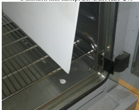
Рисунок 3 – Процес пришвидшеного старіння вогнезахисного покриття
