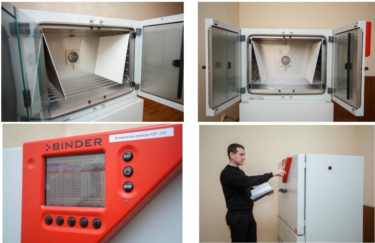
Рисунок 2 – Проведення пришвидшених кліматичних випробувань вогнезахисного покриття в кліматичній камері BINDER KBF 240
