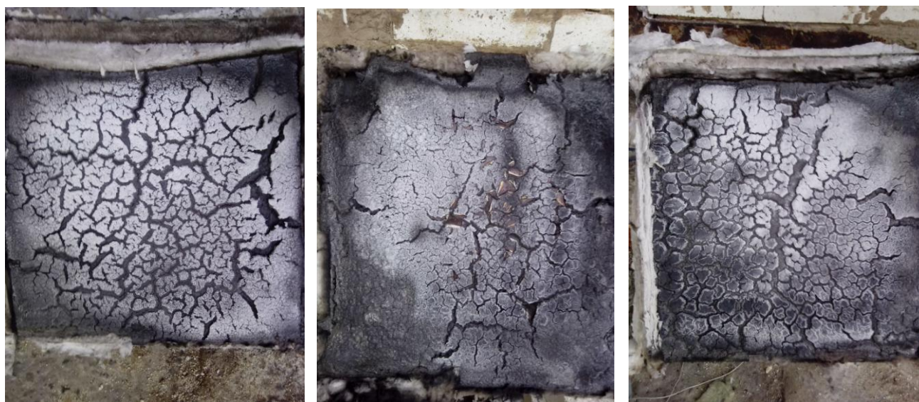
Рисунок 7 – Характерний вигляд спученого вогнезахисного покриття після вогневого впливу
