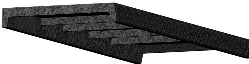
Рисунок 2 – Кінцево-елементна модель залізобетонної ребристої панелі покриття.
