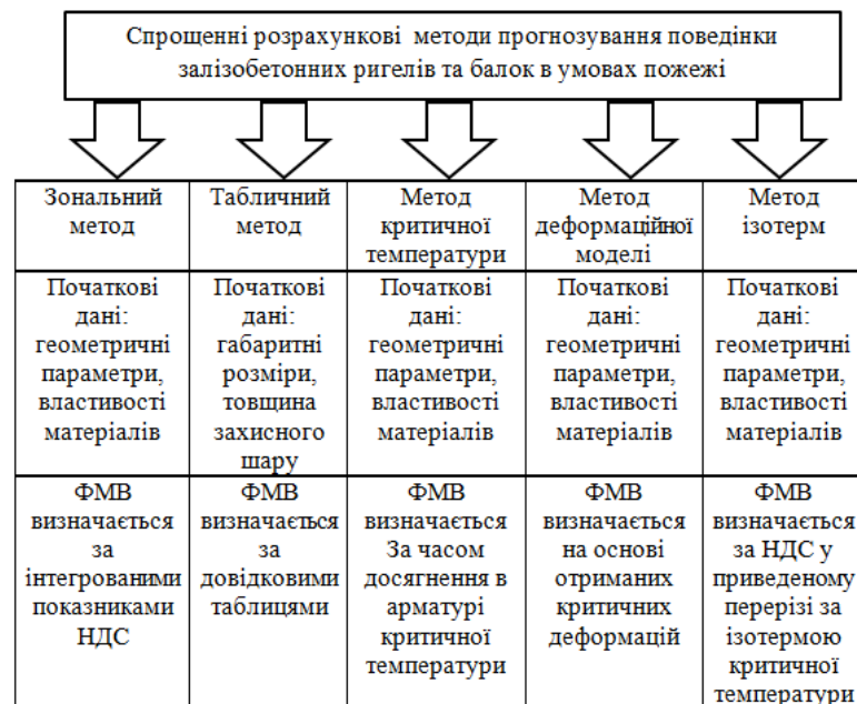
Рисунок – 1.6. Структурна схема спрощених розрахункових методів прогнозування роботи залізобетонних ригелів та балок в умовах дії високих температур
