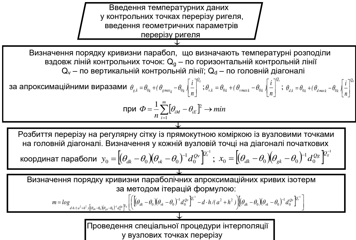
Рисунок – 2.19. Блок-схема алгоритму для обчислення величин температур у вузлових точках у перерізі залізобетонного балки та ригеля
