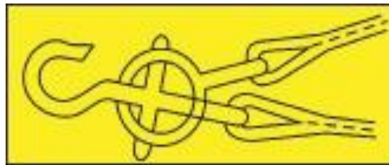
Рисунок 3.10 – Гак троса волокуші з обмежувачем
