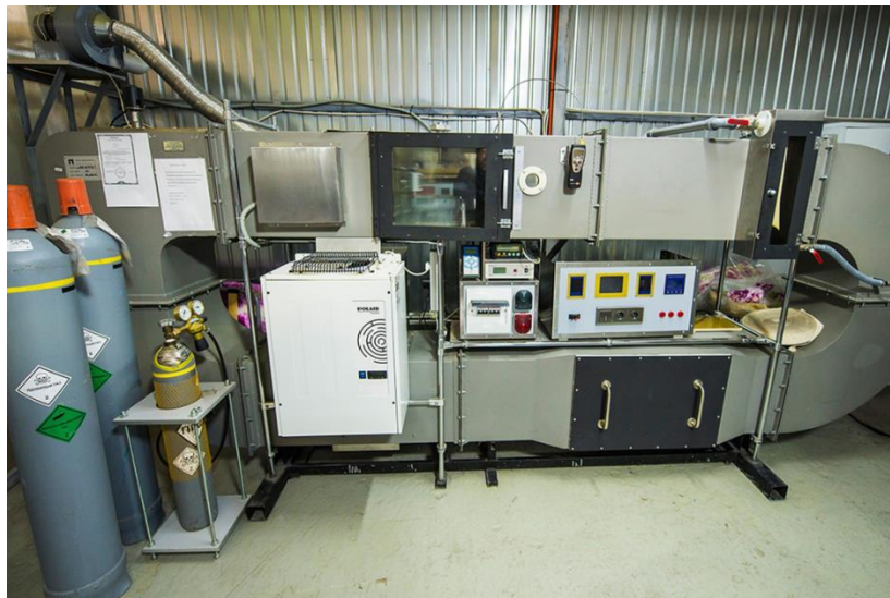
Рисунок 1 – Установка для стаціонарних випробувань пожежних сповіщувачів
