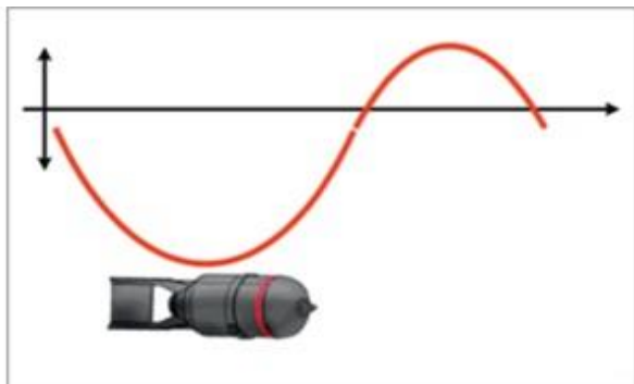
Рисунок 1 – Особливості сигналів глибинного магнітометра при виявленні горизонтально розташованих об'єктів
