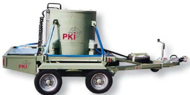
Рис. 3. PKI 9275 Причепна система для перевезення ВВП
