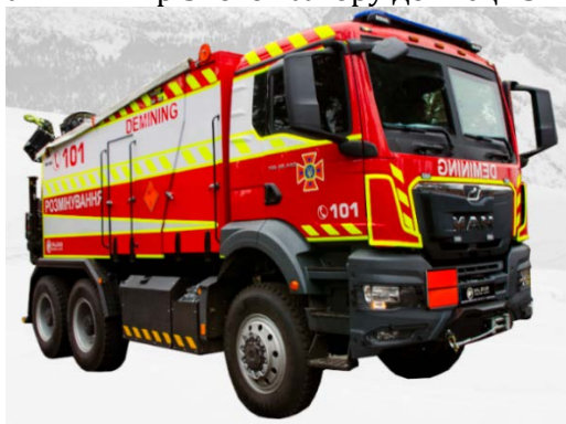
Рис.2. ПМ-В на базі автомобіля MAN TGM
