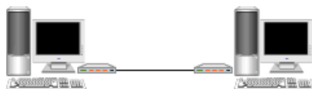
Рис. - З'єднання типу "точка-точка"
