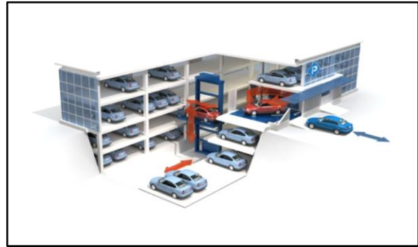
Рис. 18.8 – Механізований гараж наземно-підземний
