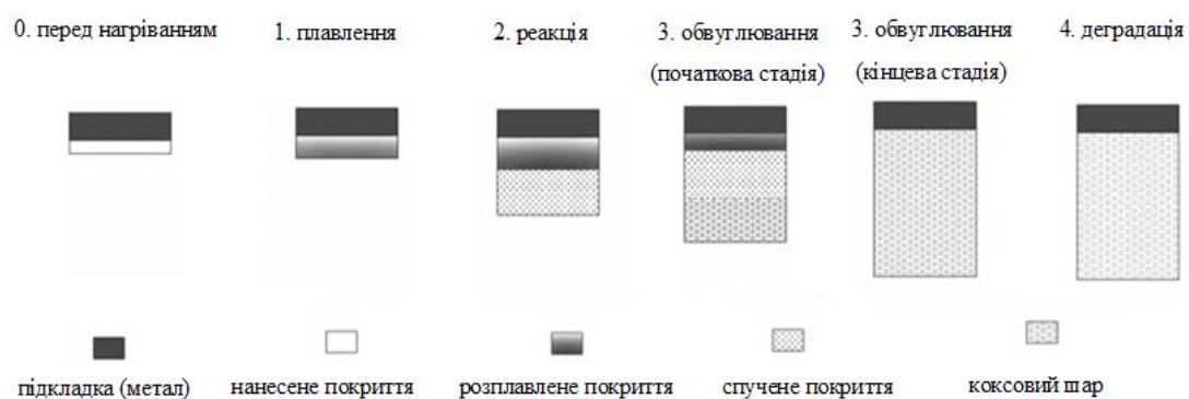
Рис. 1.6 – Етапи спучення інтумесцентного вогнезахисного покриття
