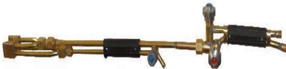
Рисунок 1 – Пальник для поверхневого гартування зубів зовнішнього зачеплення ГЗУ-6-КМ10. Модуль 10.
