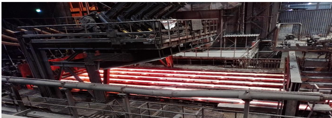
Рисунок 1 – Загальний вигляд МБЛЗ під час розливу сталі
