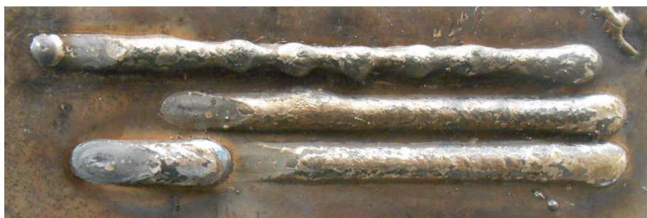
Рисунок 2 – Наплавлені валики під час механізованого процесу: 1-звичайна подача; 2, 3 – з новим способом
