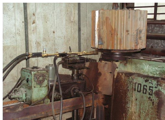
Рисунок 2 – Машинне гартування зубів шестерні модулем 25
