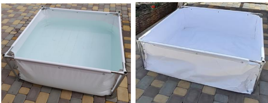
Рис. 3. Загальний вид розбірної проміжної ємності з водою (ліворуч) та без води (праворуч).
