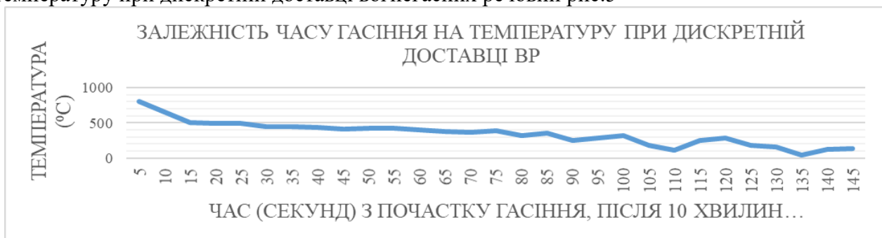
Рис.5 Графік залежності часу гасіння на температуру при дискретній доставці ВР
