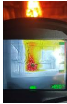
Рис.3 а) Температура в осередку пожежі на 10 хвилину вільного розвитку
