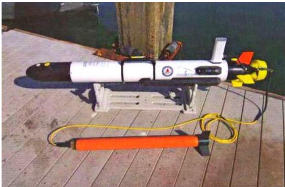
Рис. 1 – Підводний дистанційно керований апарат AUV Iver 3 з магнітометром Marine Magentics
