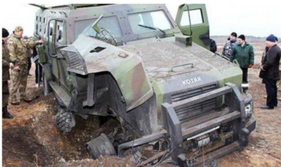
Рис.2 – Український броньовані автомобіль КОЗАК-2 після проведення випробування шляхом імітації наїзду на протитанкову міну вагою бкг
