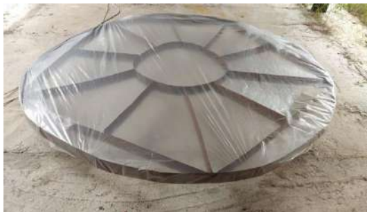
Рис. 2. Відокремлювач у вигляді перетинки, що легко руйнується.
