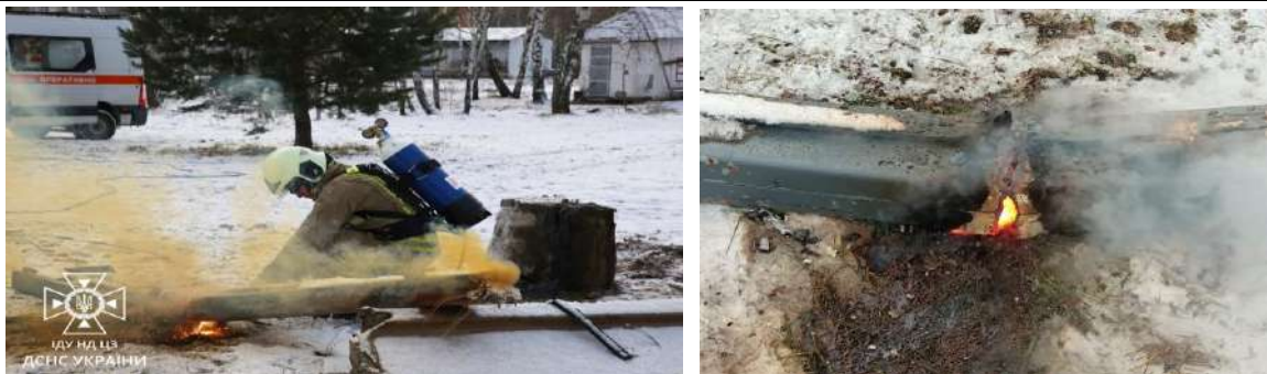
Рис. 2. Робочий момент різання металевого квадрата та його зовнішній вигляд після різання.
