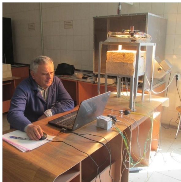
Рис. 1 – Установка для дослідження теплових режимів ґрунтів
