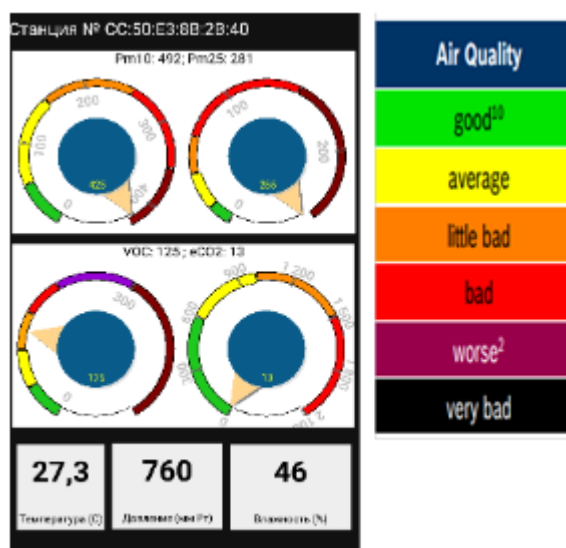
Рис. 4 – Скріншот робочого екрану монітору роботи станції прямих вимірів (ліворуч) та позначення кольорів індикації спектрів кількості наявності домішок у повітрі(праворуч)
