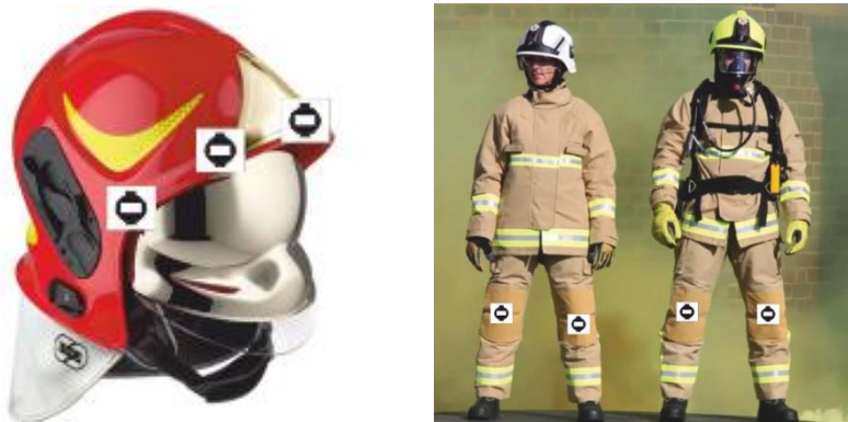
Рис. 6. Схема розміщення акустичних датчиків на захисному шоломі рятувальника (⊗ – акустичний датчик)
