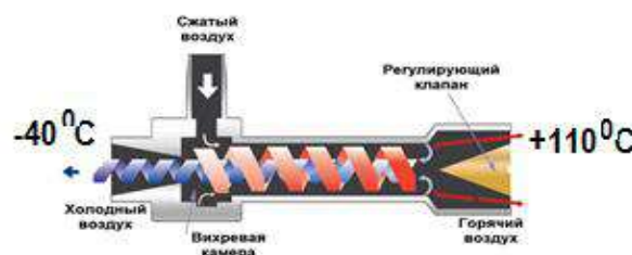
Рис. 1. Трубка Ранка-Хілша.
