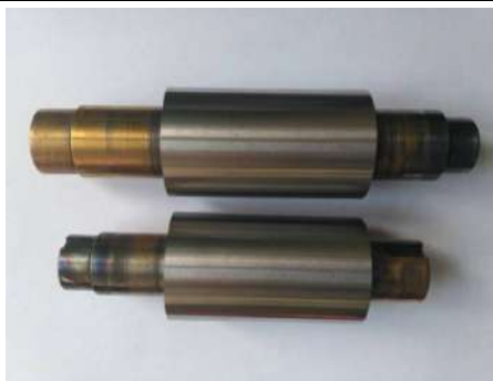
Рис. 1. Пара прокатних валків (Сталь 40Х), які потребують відновлення робочих властивостей.
