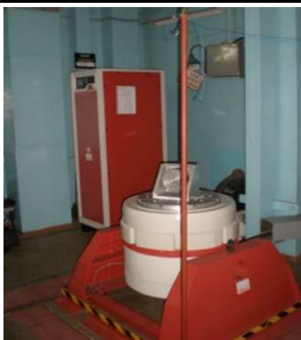
Рис. 1. Зовнішній вигляд установки для вимірювання випадкової вібрації.
