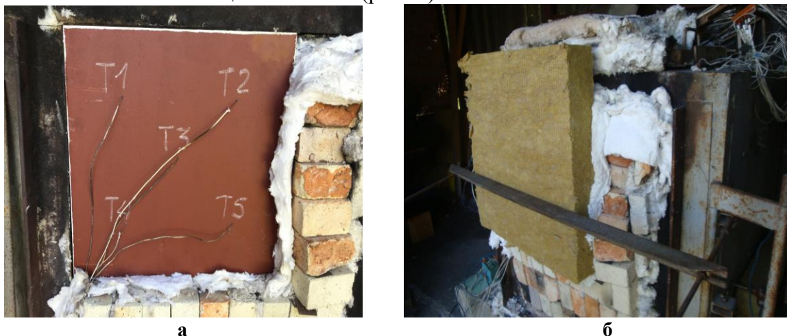
Рис. 2. Схема розміщення термопар (а) та вигляд зразка з необігрівної поверхні сталеві пластина (б), товщиною 5 мм з мінімальною товщиною вогнезахисного покриття, в точках вимірювання (спучення покриття від 3,2 мм до 4,5 мм)
