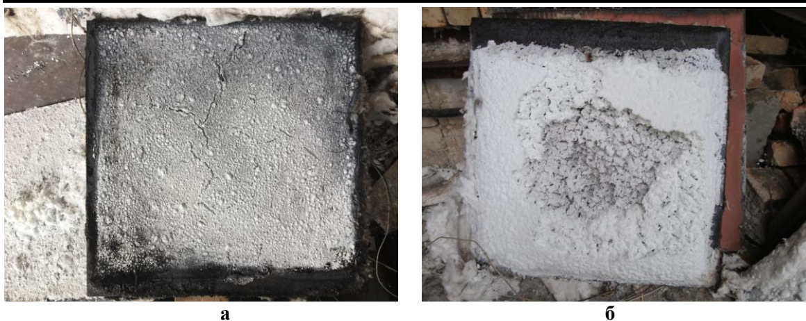
Рис. 5. Загальний вигляд зразка сталевієї пластини товщиною 5 мм з вогнезахисним покриттям після випробувань: а – з мінімальним значенням товщини покриття; б – з максимальним значенням товщини покриття
