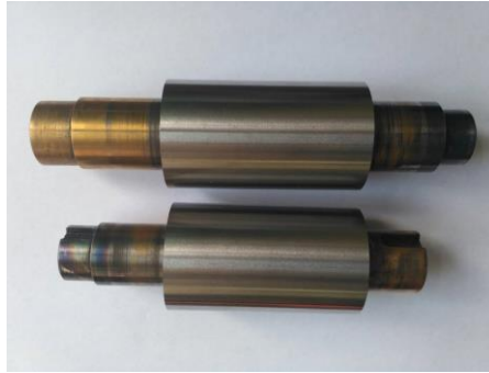
Рис. 1. Пара прокатних валків (Сталь 40X), які потребують відновлення робочих властивостей
