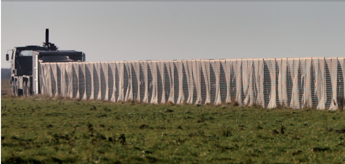
Рис. 4. Система швидкого встановлення RAID (Rapid in-theatre Deployment).
