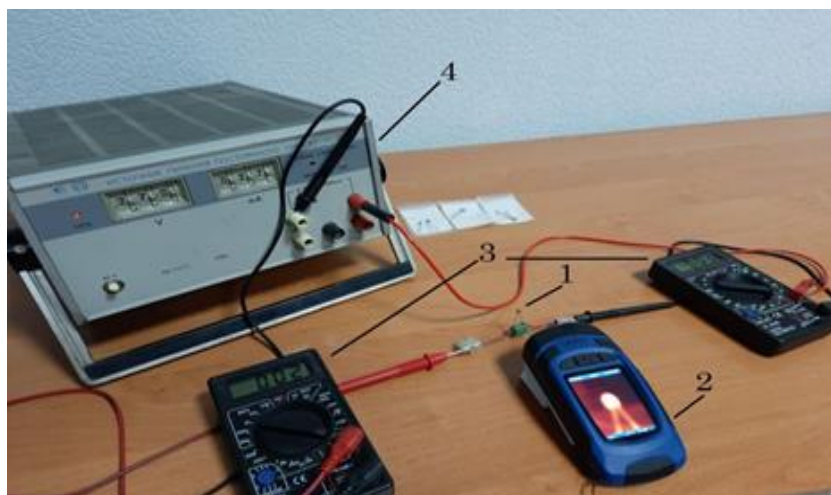
Рис. 1. Макет для проведення випробувань визначення температури терморезистора: а) 1 – терморезистор, 2 – тепловізор, 3 – мультиметри; 4 – джерело живлення
