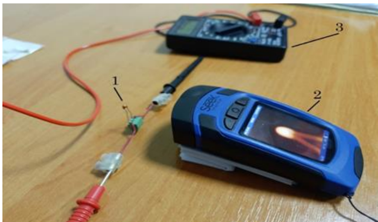
Рис. 2. Макет для проведення випробувань визначення температури терморезистора: а) 1 – терморезистор, 2 – тепловізор, 3 – мультиметри
